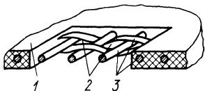
Рис. 87. Трафарет: 1 — фоторезист, 2 — открытые ячейки сетки, 3 — сетка
